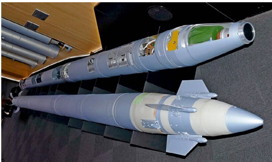
Рис. 1.24. Зовнішній вигляд головних частин керованого реактивного снаряда
