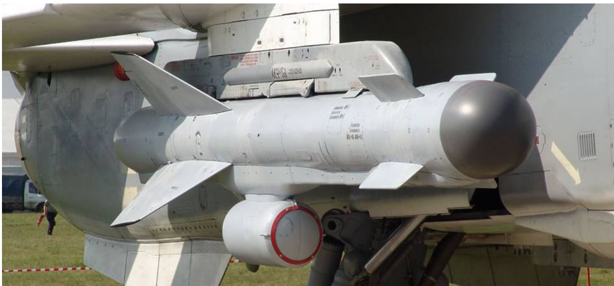
Рис. 2.15. Зовнішній вигляд крилатої ракети X-59МК
