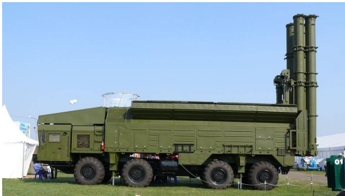
Рис. 3.8. Зовнішній вигляд пускової установки з крилатими ракети 9М729
