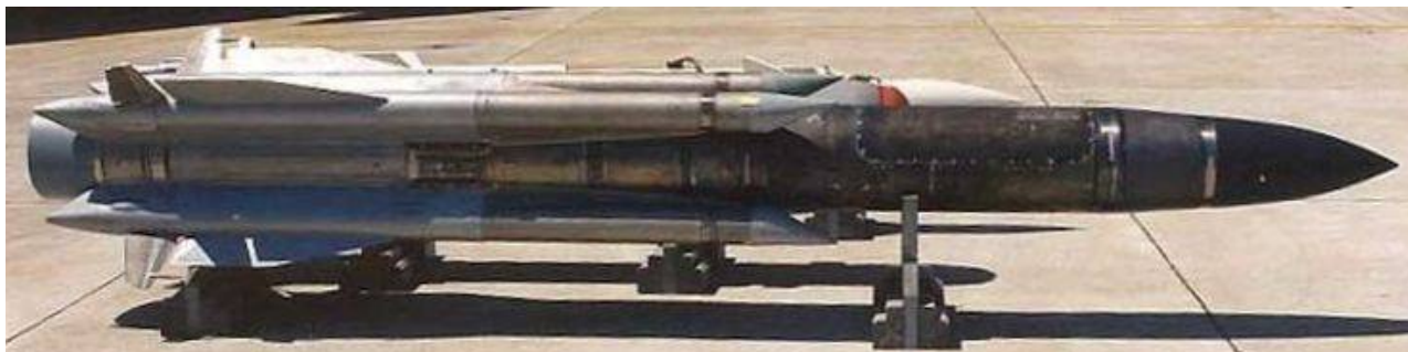
Рис. 2.12. Зовнішній вигляд керованих ракет типу Х-31П, Х-31А
